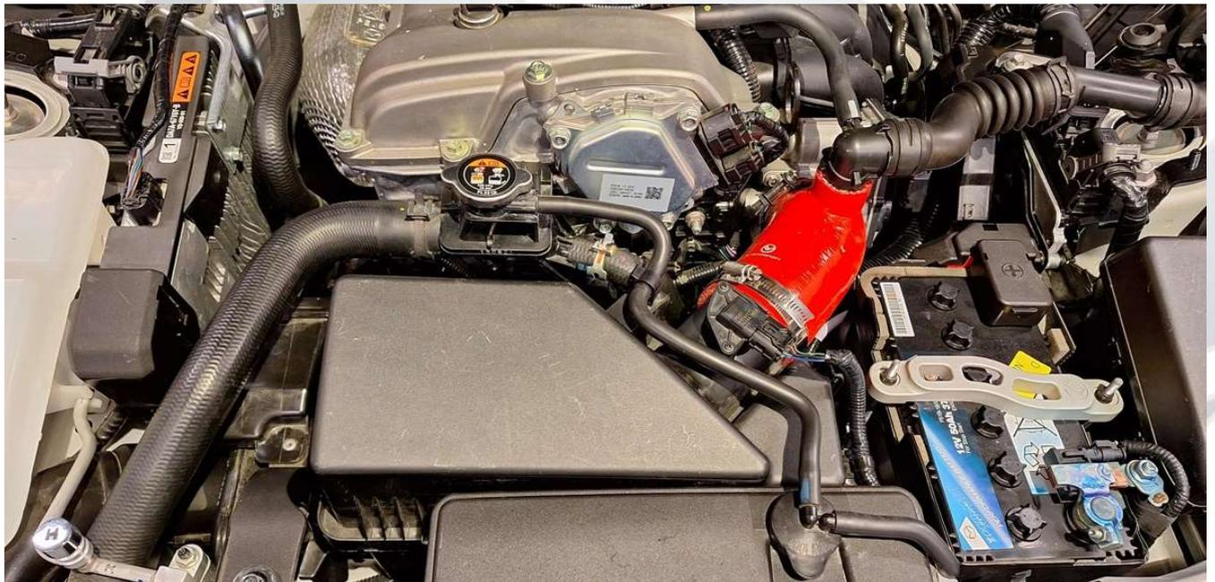
1. Ziehen Sie den Stecker des Luftmassenmessers ab. Drücken Sie mit einer gekrümmten Spitzzange den Halter zusammen und ziehen ihn aus der Halterung.
