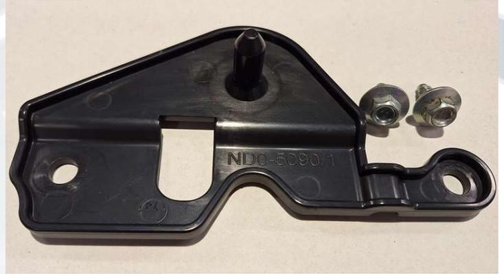
8. Montieren Sie den Halter (E) mit den originalen Schrauben. Drücken Sie danach den originalen Haltegummi in die dafür vorgesehene Öffnung an der Unterseite des Luftfiltergehäuses und montieren den originalen Schwingungsdämpfergummi mit Hülse.
