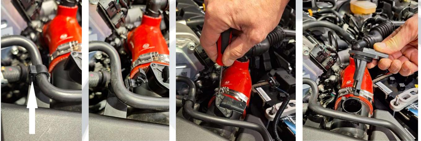
3. Lösen Sie beide Schellen des Ansaugschlauches, ziehen Sie den Resonanzschlauch aus der Öffnung und legen ihn beiseite. Nun kann der Ansaugschlauch entnommen werden.
